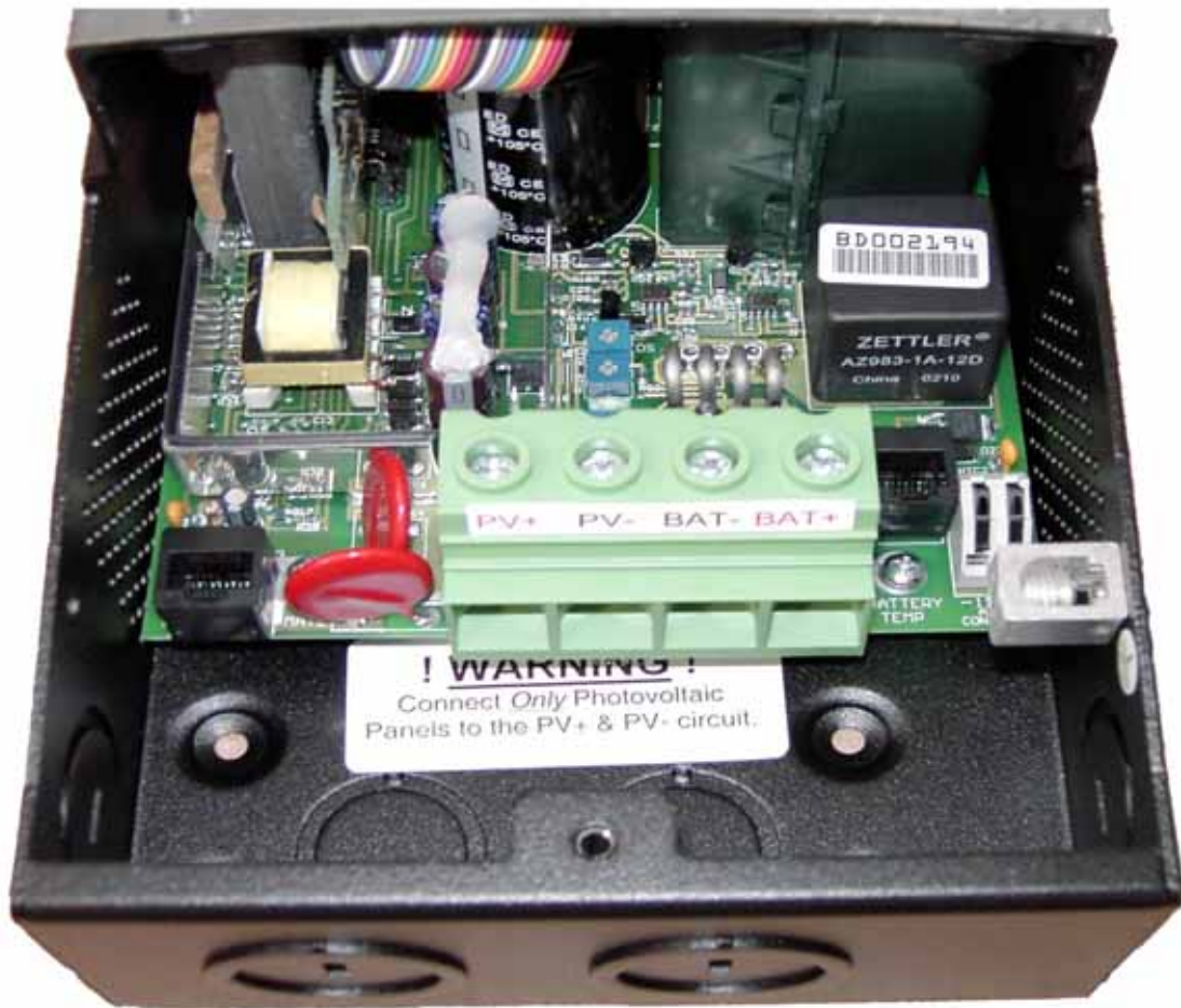
Fig. 3 Compartimiento de alambrado y ubicación de terminales del MX60
