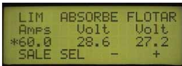
Fig. 10 pantalla de Parámetros de Carga.
