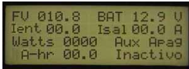
Fig.9 Pantalla de Estado mostrando A-hr en lugar de Kw-hr
